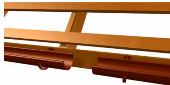
возможный монтаж сливной воронки, или для соединения 2 жёлобов
