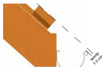
Монтаж без снегозадержателей
